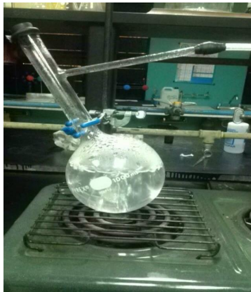
Imagen N°2 matraz de destilación de 1000 ml al momento de hervir.
