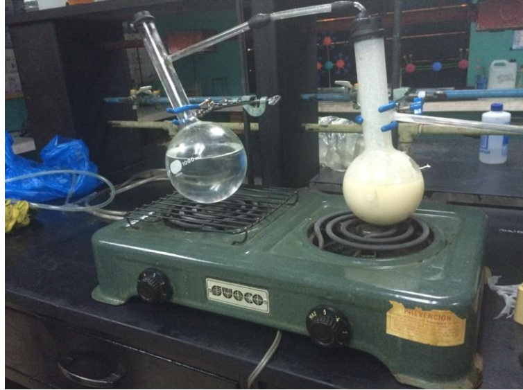
Imagen N°1 Vista de los matraces de destilación con tubo de desprendimiento lateral dispuestos de forma paralela sobre la cocinilla.
