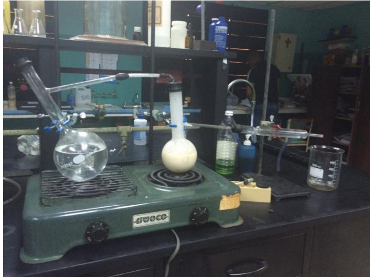
Imagen N°3 Vista del sistema completo de destilación
